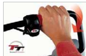
Beim patentierten IBEA Twist-Traction Antriebssystem erfolgt die Geschwindigkeitsregelung mittels Drehgriff.
