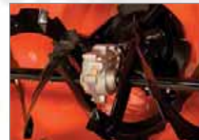
Robustes Fräsgetriebegehäuse aus Aluminium
